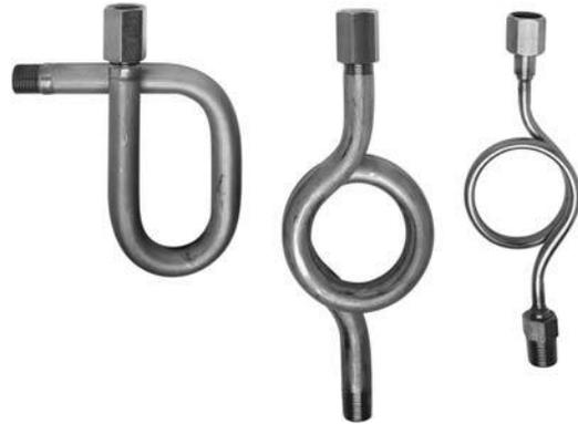
Los tubos sifones son utilizados en la medida de presiones de vapor y colocados entre los instrumentos de medida (manómetros, presostatos, sensores) y el proceso. Una parte del tubo permanece siempre llena de condensación e impide así el contacto directo con el vapor a alta temperatura. Otra utilización de estos accesorios es la dispersión del calor, protegiendo al manómetro de tener que trabajar a temperaturas peligrosas para su funcionamiento.
